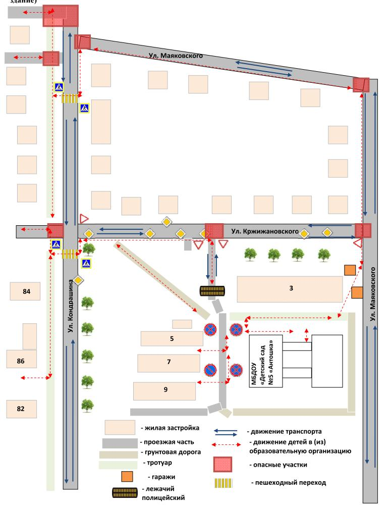
2. Схема организации дорожного движения в непосредственной близости от образовательной организации с размещением соответствующих технических средств организации дорожного движения, маршрутов движения детей и расположения парковочных мест (Модульное здание)
